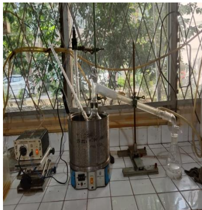
Melakukan proses distilasi untuk mendapatkan ekstrak biji pepaya
