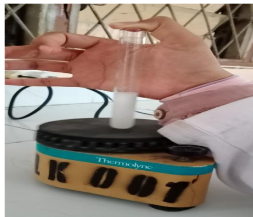
Melakukan analisa tinggi busa dengan menggunakan vortex
