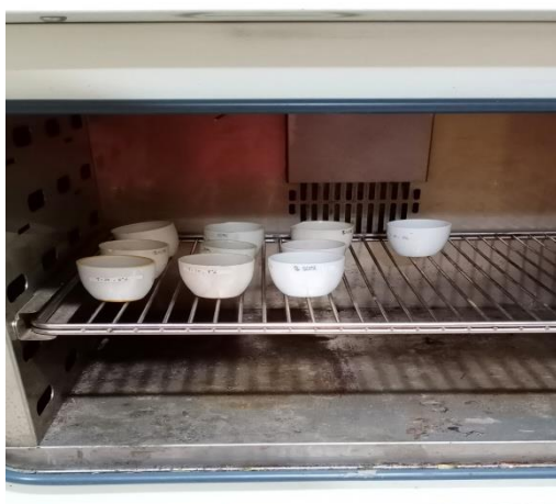
Memasukkan sampel ke dalam oven pada suhu 115^{\circ}\text{C} selama 2 jam untuk melakukan analisa kadar air
