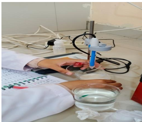
Melakukan analisa pH menggunakan pH meter
