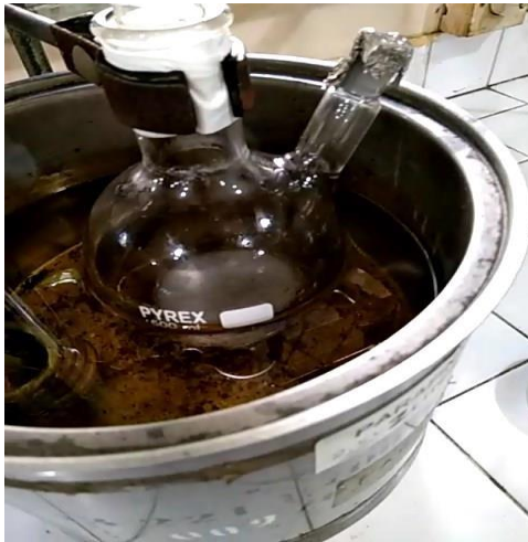
1) Campuran vco dan ekstrak telang dilarutkan dalam 25ml NaOH 0,5M, kemudian di refluks selama \pm 30 menit.
