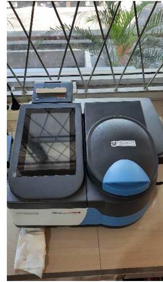
Proses Analisis Kandungan Akhir Fe dan Mn Pada Sampel Air Gambut dengan Multimeter Digital , Uv-Vis Spectrophotometer , dan Atomic Absorption Spectrophotometry
