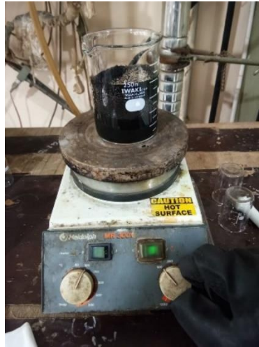
Mengontakkan Karbon Aktif Sabut Kelapa Muda dengan Sampel Air Gambut dengan Variasi Massa Adsorben dan Waktu Kontak
