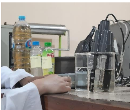
Proses Analisis Kandungan Awal Fe dan Mn Pada Sampel Air Gambut dengan Multimeter Digital , Uv-Vis Spectrophotometer , dan Atomic Absorption Spectrophotometry
