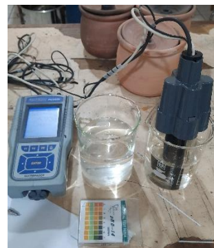
Proses Analisis Kandungan Awal Fe dan Mn Pada Sampel Air Gambut dengan Multimeter Digital , Uv-Vis Spectrophotometer , dan Atomic Absorption Spectrophotometry
