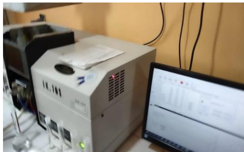
Gambar 23. Uji kadar Fe menggunakan AAS
