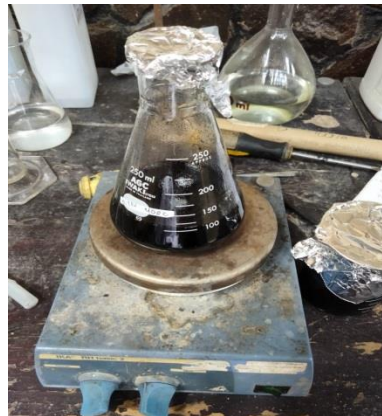
Gambar 20. Pengontakkan adsorben dengan larutan Fe selama 2 jam dengan pengadukan selama 1 jam dengan kecepatan 100 rpm
