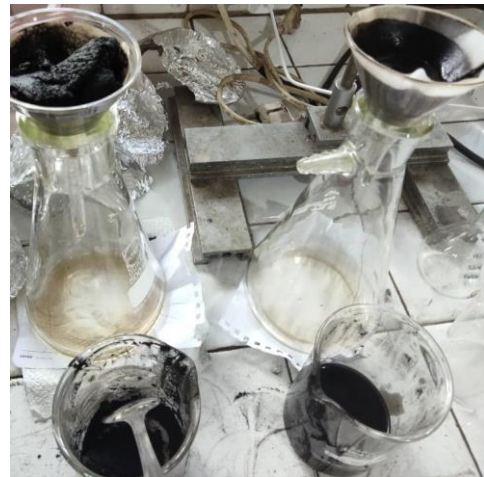
Gambar 10. Setelah dicuci filtrat cukup jernih dan mempunyai pH 7, karbon aktif diambil dan dipisahkan dari filtrat
