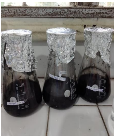
Gambar 7. Proses aktivasi karbon menggunakan aktivator KOH selama 24 jam
