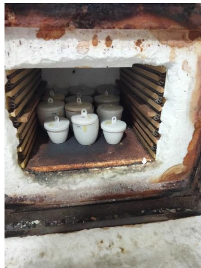
Gambar 16. Uji kadar abu
