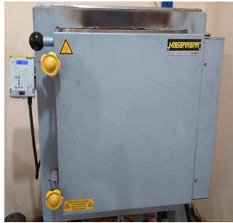
Gambar 2. Proses karbonisasi pada temperatur 300°C, 350°C dan 400°C selama 30 menit
