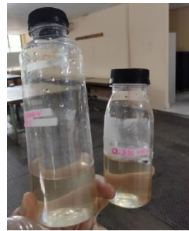
Gambar 22. Larutan Fe yang telah dikontakkan dengan adsorben
