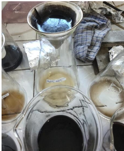
Gambar 9. Pencucian dan penyaringan karbon aktif hingga didapat pH 7
