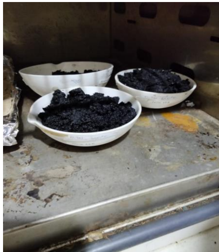
Gambar 11. Pengeringan karbon aktif selama 1 jam
