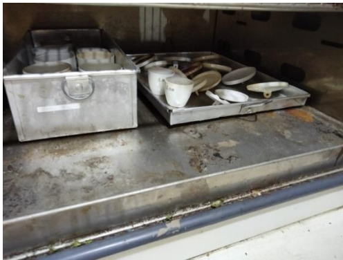
Gambar 13. Pengeringan cawan selama 1 jam sebelum melakukan uji kadar air, kadar abu dan kadar zat mudah menguap
