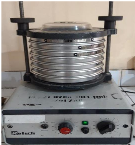
Gambar 5. Pengayakan pada ukuran 70 mesh
