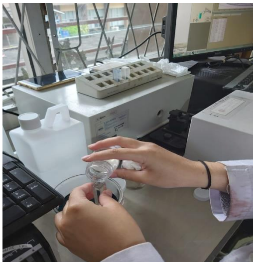
Gambar C.9 Analisis aktivitas antioksidan teh daun insulin menggunakan alat spektrofotometer 3uv-vis
