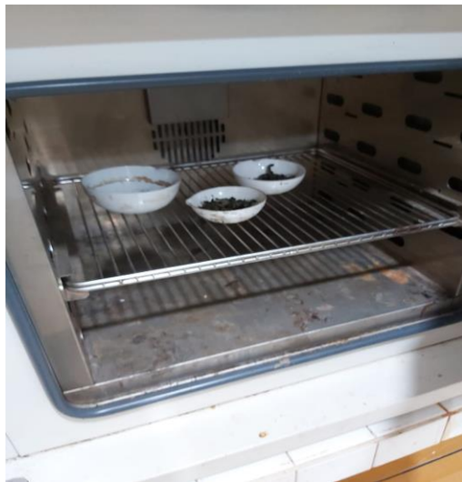
Gambar C.7 Analisis kadar air menggunakan oven selama 2 jam, suhu 105°C
