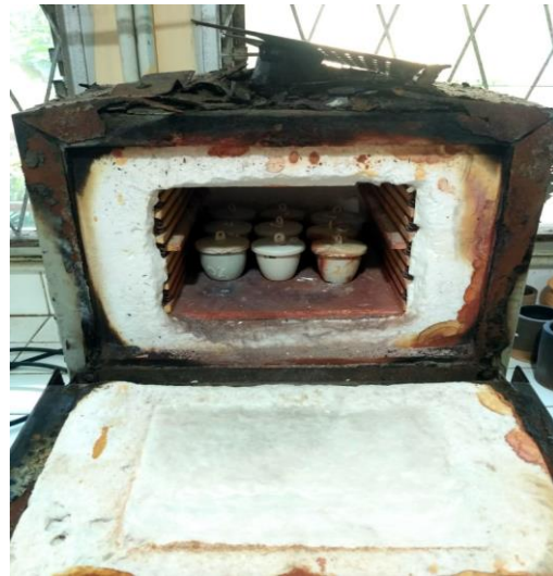
Gambar C.8 Analisis kadar abu menggunakan furnace selama 600°C, selama 3 jam
