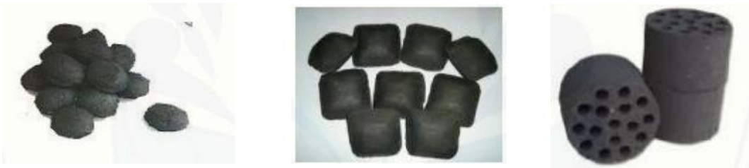
a) Briket berbentuk telur b) Briket berbentuk bantal c) Briket sarang lebah
