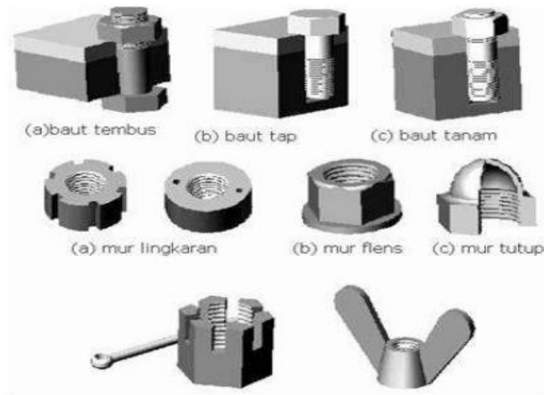
Gambar 2.6.1 Macam-macam baut dan mur
