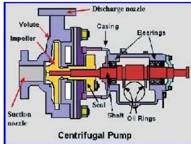
Gambar 2.8 Pompa *Sentrifugal*
