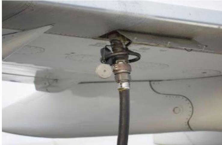
Gambar 2.5 *Fill Valve* dibawah sayap pesawat
