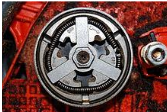
Gambar 2.3 Kopling Sentrifugal. (Sumber: Lit. 3)
