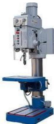
Gambar 2.8 Mesin Bor tegak
