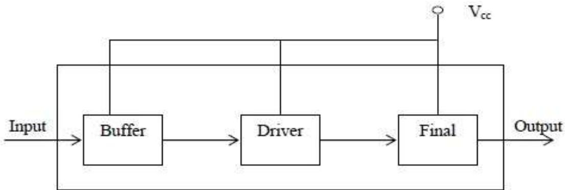
**Gambar 2.1 Blok Diagram Penguat RF**
