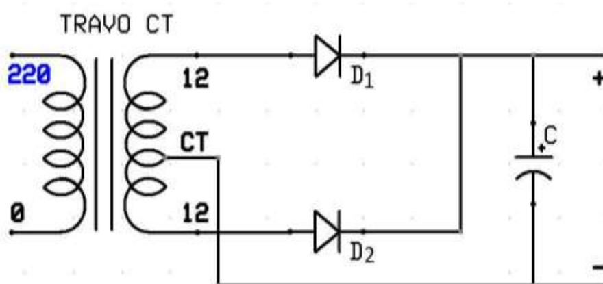
**Gambar 2.14 Rangkaian penyearah gelombang penuh 2 dioda**
