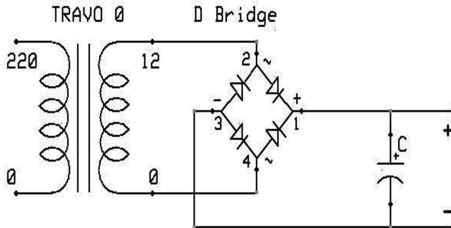
**Gambar 2.15 Rangkaian penyearah gelombang penuh 4 dioda (bridge/jembatan)**
