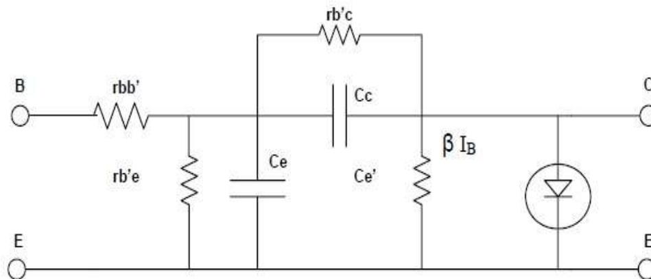
**Gambar 2.8 Rangkaian Ekivalen Transistor Pada Frekuensi Tinggi**
