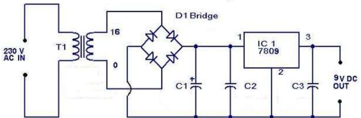
**Gambar 2.16 Rangkaian Catu Daya dengan IC 7809**
