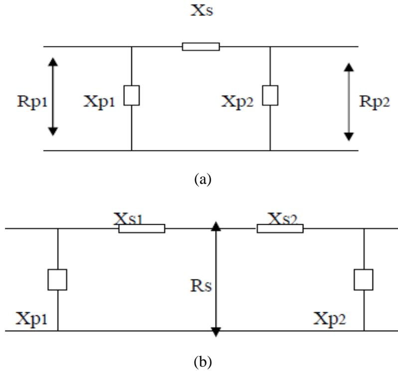
**Gambar 2.12 Rangkaian Penyesuai Impedansi Tipe  $\pi$  (a) Rangkaian Tipe  $\pi$  dengan 3 elemen, (b) Rangkaian Tipe  $\pi$  sebagai susunan dari 2 buah rangkaian L**
