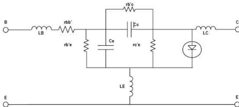
**Gambar 2.9 Rangkaian Ekivalen Transistor dengan Induktansi Kakinya**
