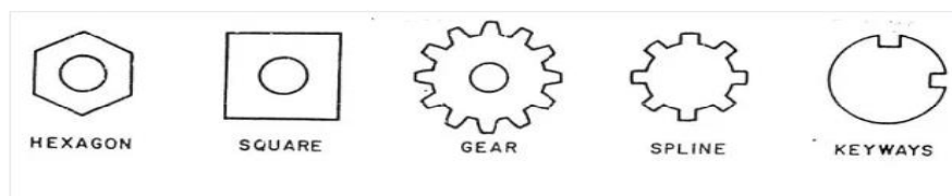
Gambar 2. 13 Benda kerja dengan menggunakan fixture Indexing
