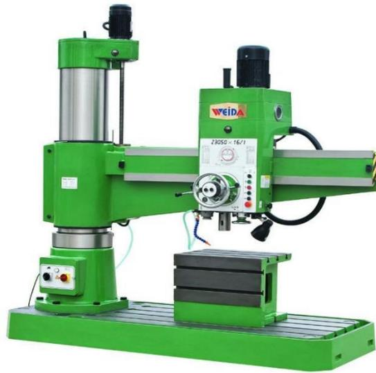
Gambar 2.7 Mesin bor radial
