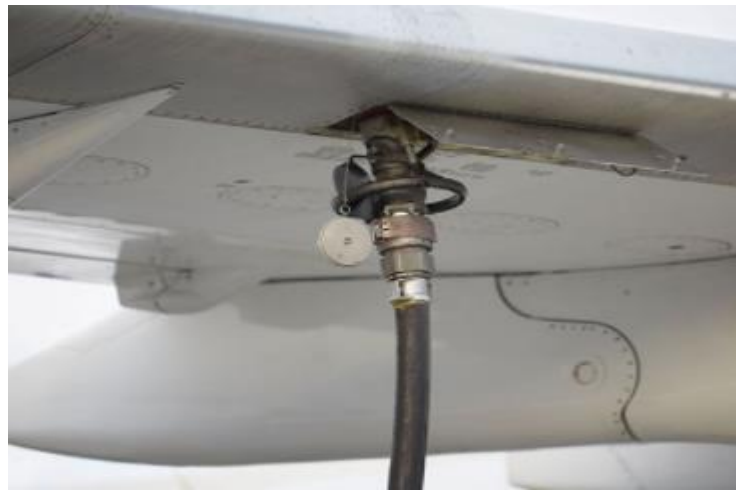
Gambar 2.5 Fill Valve dibawah sayap pesawat [7]
