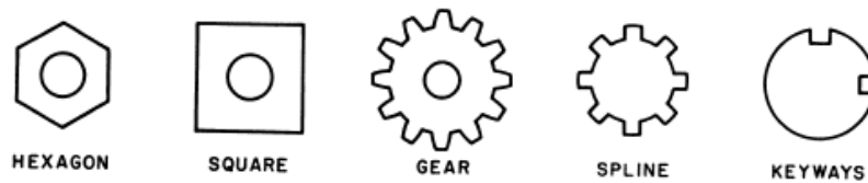
Gambar 2.8 Benda Kerja Yang Di Mesin Dengan Fixture Index
