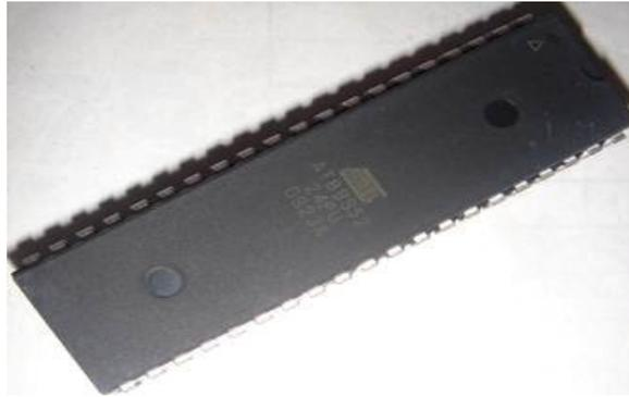
**Gambar 2.2 Bentuk Chip Mikrokontroler AT89S52**
