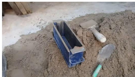
Gambar 1.1 Alat Cetak Batako Manual [10]
