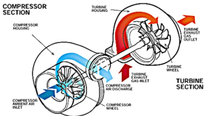
Gambar 2.7 Komponen *Turbocharger* [6]
