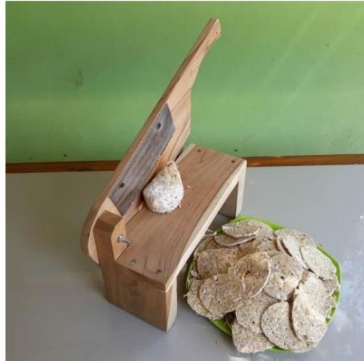
**Gambar 2.1** Pemotong Keripik Tempe manual [10]
