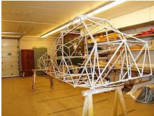
**Gambar 2.5** Rangka Pesawat terbang
