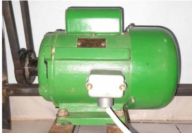
**Gambar 2.6** Motor listrik penggerak
