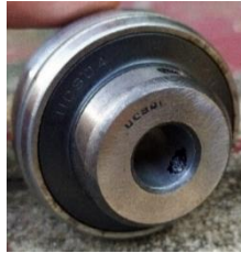
Gambar 2.11 Bantalan ( Bearing ) (Sumber: Dokumentasi)
