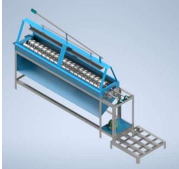
Gambar 2.2 Desain awal alat pencacah sabut kelapa
