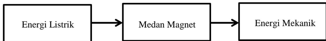
**Gambar 2.14. Proses Konversi Energi pada Motor DC**
