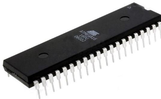
**Gambar 2.1. Mikrokontroler ATmega16**
