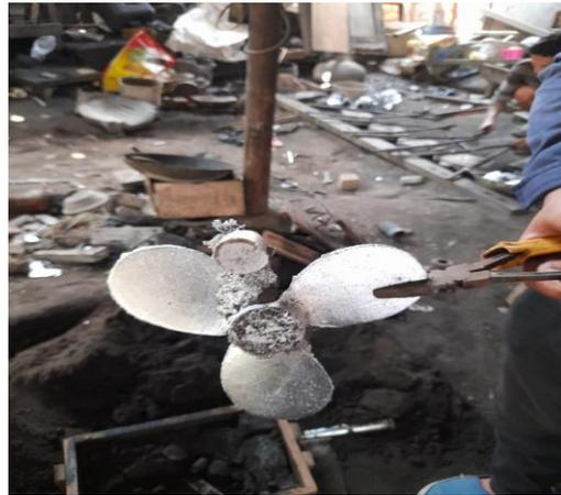
Gambar 3.10 Hasil Pembuatan Propeller
