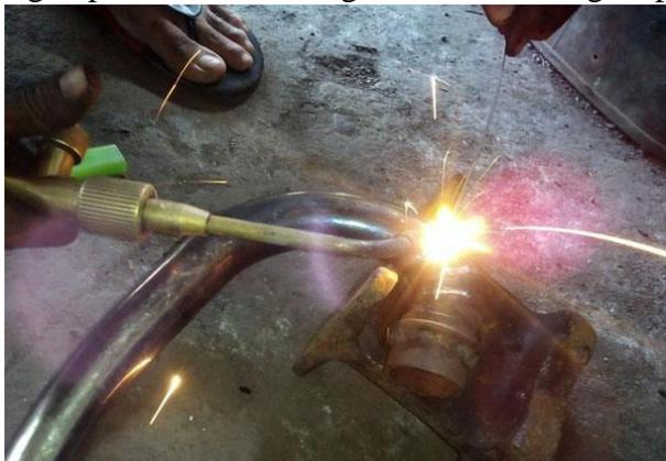
**Gambar 2.21 Mesin Las Karbit**
