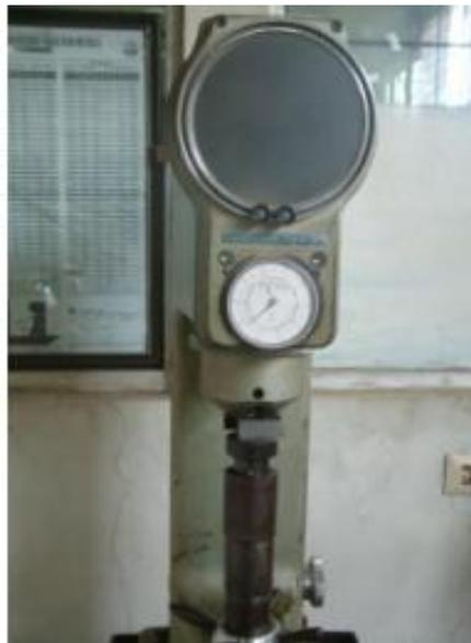
Gambar 2.5. Mesin Uji Kekerasan *rockwell* [17]
