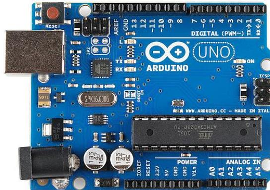
Gambar 2.3 Mikrokontroler Arduino UNO [13]
