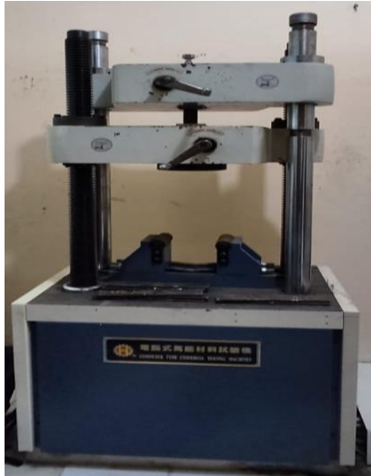
Gambar 2.7 Mesin uji tarik
