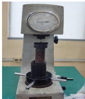
Gambar 2.4 Alat uji kekerasan Rockwell
