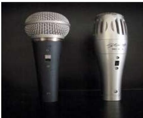
**Gambar 2.16 Mikrofon Kapasitor**
