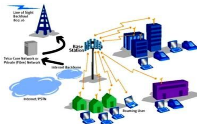
Gambar 2.4 Konfigurasi Umum Jaringan Wimax untuk aplikasi MAN ( Sumber : http://www.scribd.com/doc/47849388/Wimax )
