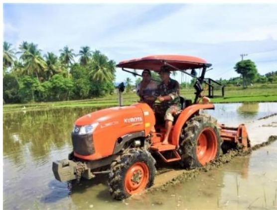
**Gambar 2.11** Alat Bajak Sawah Modern Menggunakan Rotavator
