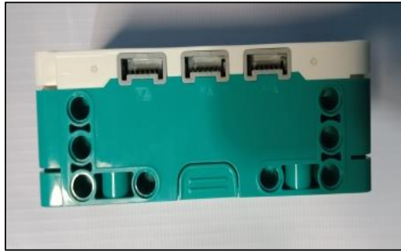
Gambar 2.9 51515 Hub Bagian Kanan
