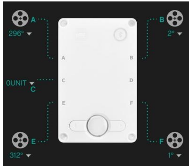
Gambar 2.13 Input dan output dari Hub
