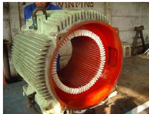
Gambar 2.2 Bentuk Konstruksi stator pada generator 3
