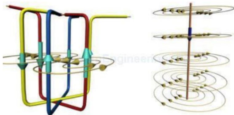
Gambar 2.13 Arus pada kabel menghasilkan fluks
