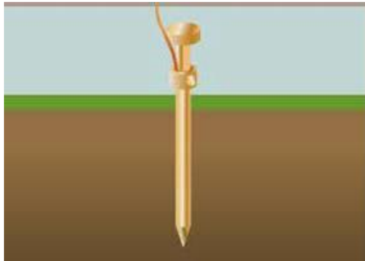
Gambar 2.3 Batang elektroda pentanahan yang ditanam di tanah.
