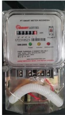
Gambar 2.4 kWh Meter Analog
