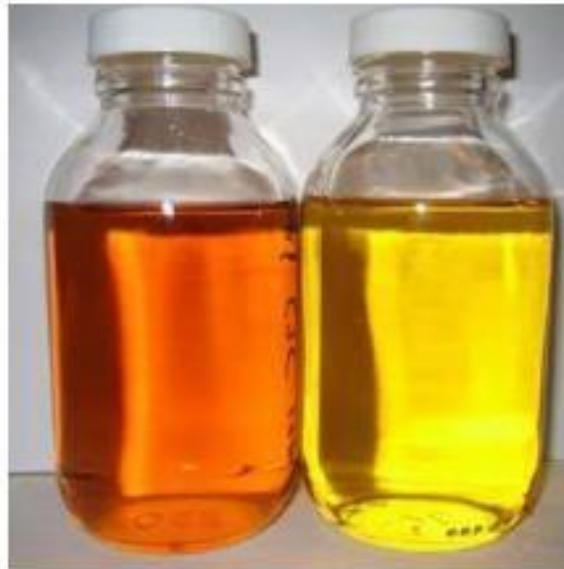
Gambar 2.6 Minyak Isolasi Trafo
