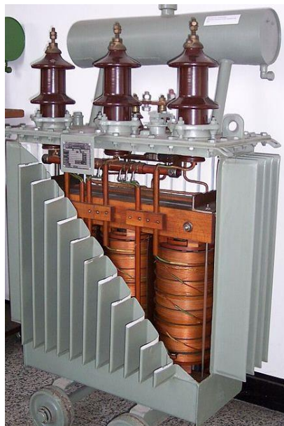
Gambar 2. 10 Komponen-komponen internal transformator
