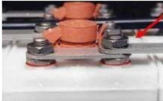
Gambar 2. 15 Terminal Penghubung Baterai
