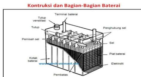
Gambar 2. 17 Kontruksi dan bagian-bagian baterai
