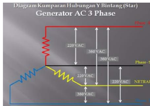
Gambar 2.12 Rangkaian Ekuivalen Generator 3 Fasa
