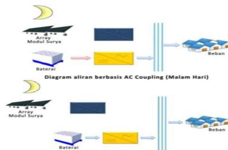
**Gambar 2. 5 Diagram Aliran Energi pada Malam Hari**
