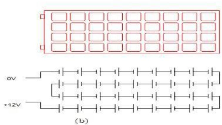
**Gambar 2. 10 Hubungan Seri Pada Solar Sel Modul**
