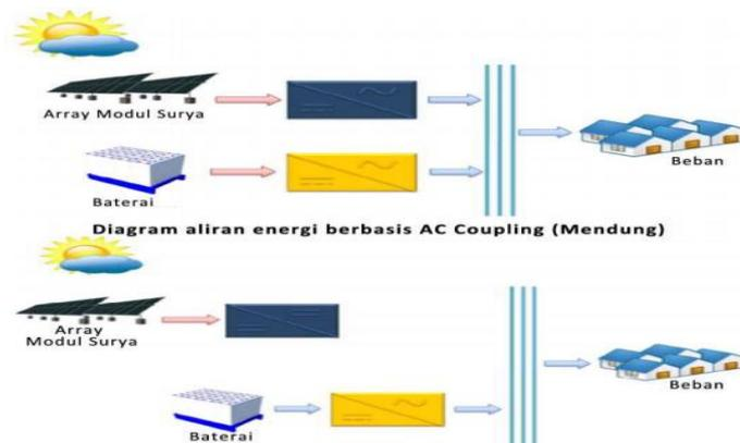
**Gambar 2. 4 Diagram Aliran Energi yang dihasilkan pada Kondisi Berawan/Mendung**
