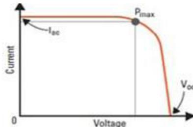
**Gambar 2. 9 Kurva arus dan tegangan**
