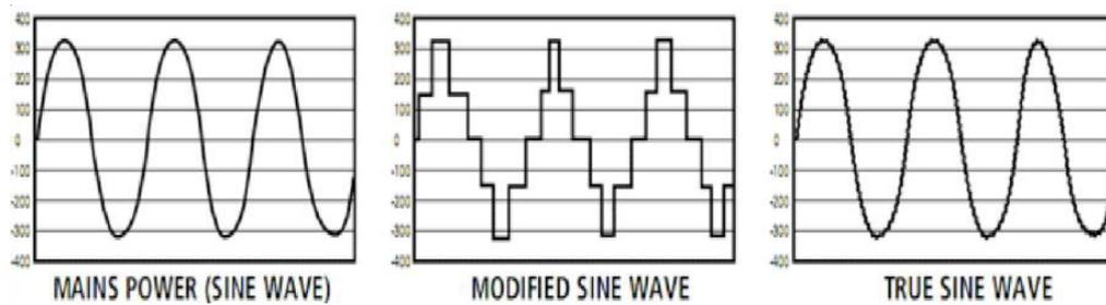
**Gambar 2. 14**Bentuk Gelombang Inverter
