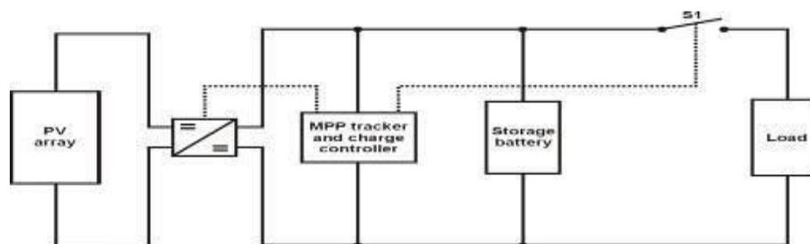
**Gambar 2. 16 Rangkaian MPP Tracker dan Charge Control PV Array**
