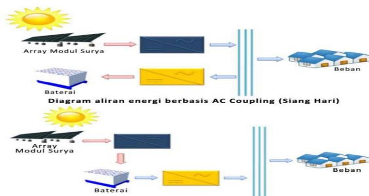
**Gambar 2. 3 Diagram Aliran Energi yang dihasilkan pada Siang Hari**
