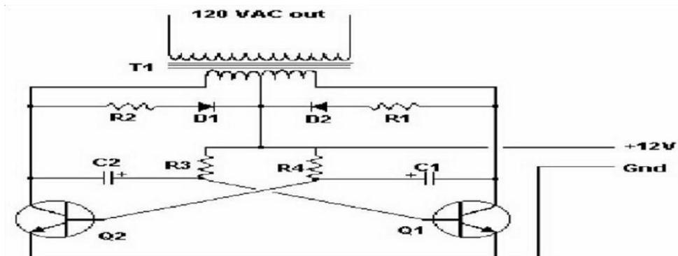
**Gambar 2. 13**Rangkaian dasar sederhana inverter
