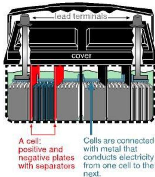
**Gambar 2. 18 Struktur Konstruksi Baterai Deep Cycle**
