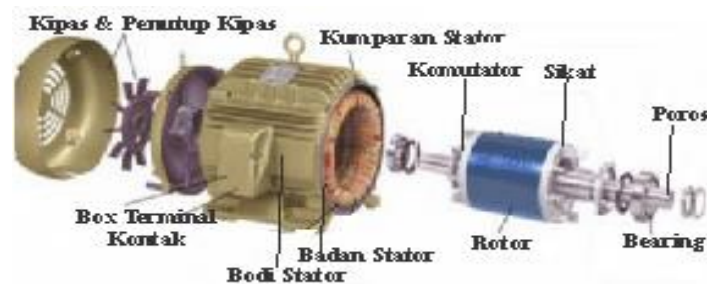
Gambar 2.4 kontruksi Motor Induksi 3 fasa
