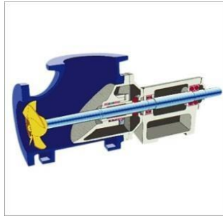
Gambar 2.21 Pompa Aliran Aksial
