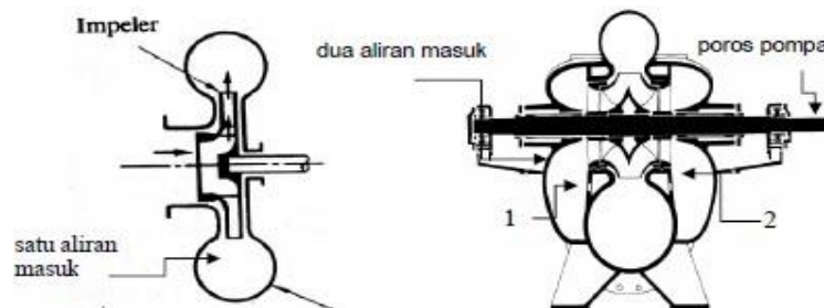
Gambar 2.29 Klasifikasi Pompa Sisi Isap Impeller
