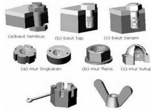
Gambar 2.15 Macam-macam baut dan mur
