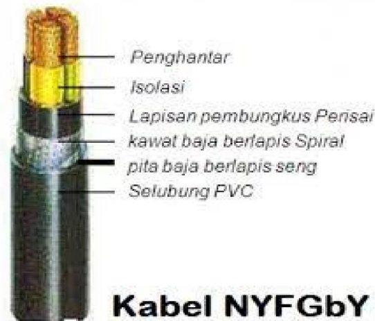
Gambar 2.13 Kabel NYFGbY
