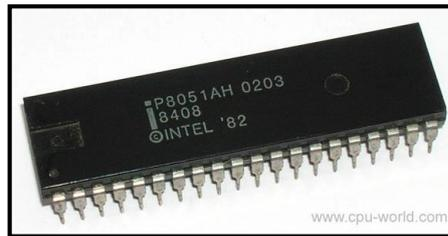
Gambar 2.1 IC Mikrokontroler 8051
