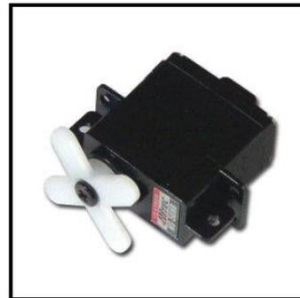
Gambar 2.12 Servo dengan horn silang
