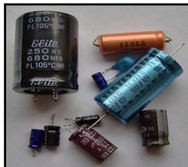
Gambar 2.24 Kapasitor Elektrolit
