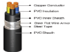
Gambar 2.5 Konstruksi Kabel NYFGbY
