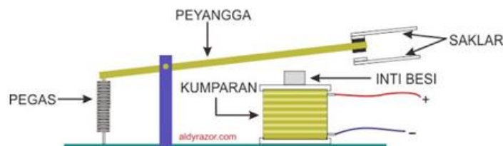
Gambar 2.11 Skematik Modul Relay
