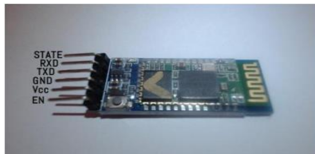
Gambar 2.9 Modul Bluetooth HC-05
